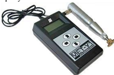
Рисунок 1 – Внешний вид твердомера МЕТ-У1
